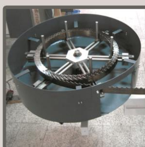
Устройство для намотки/размотки ленточных пил
