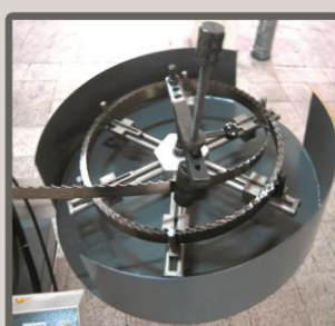
Устройство для намотки/размотки ленточных пил
