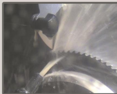
Автоматический скос правой фаски
